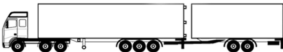
Trekker + oplegger + middenas-aanhangwagen
