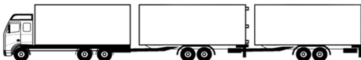
Vrachtwagen + middenas-aanhangwagen + middenas-aanhangwagen
